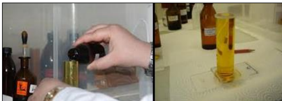
Figura 5.1 Utilización de cámaras de sedimentación para la preparación de las muestras de fitoplancton según el método de Utermöhl.
